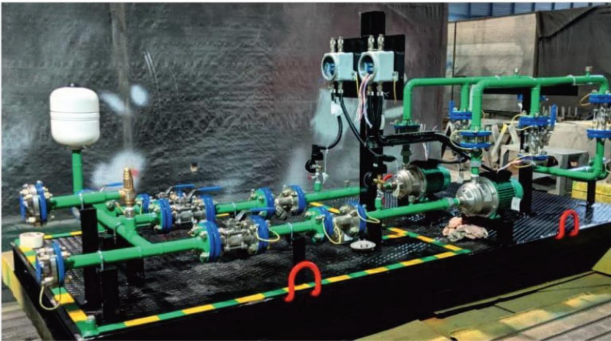
Блок может включать в себя все вышеперечисленные составляющие или их части, поступает на монтажную площадку в полностью собранном виде или поставочными единицами.
